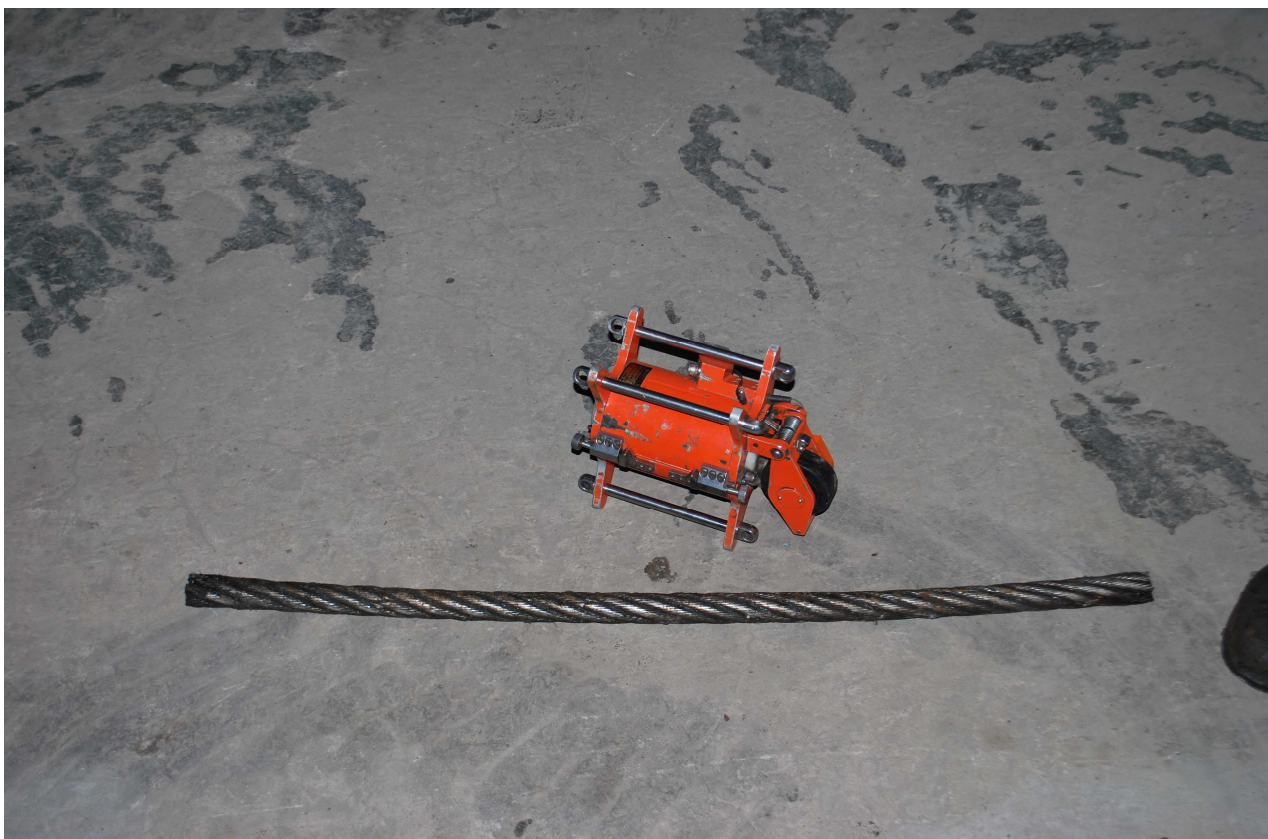
Фиг.3. Фотография вырезанного дефектного участка длиной 1.0м.
