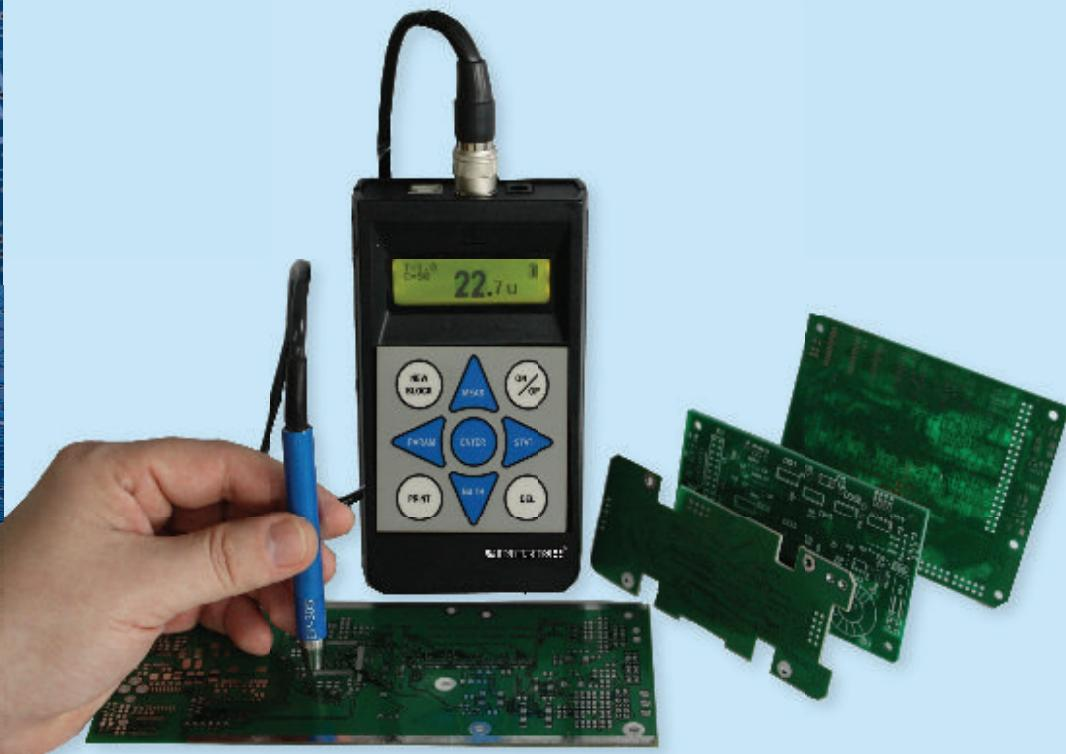
**ИНТРОМЕТ** предназначен для неразрушающих измерений толщины медного слоя в отверстиях печатных плат (ПП) и на поверхности диэлектрика, в том числе на ПП. Приборы могут применяться на любой стадии производства, что предоставляет широкие возможности для обеспечения высокого качества плат. Измерение толщины металлизации в отверстиях ПП основано на вихревоковом методе, а измерение толщины медного покрытия на поверхности - на электропотенциальном методе.
