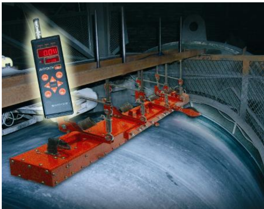
Рис.1. Дефектоскоп ИНТРОКОН для контроля металлотросовой основы резинотросовых конвейерных лент
