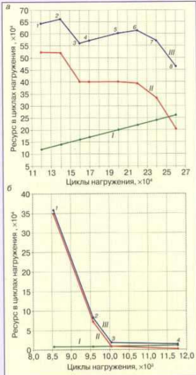
Рис. 3. Изменение ресурса в процессе эксплуатации каната:
