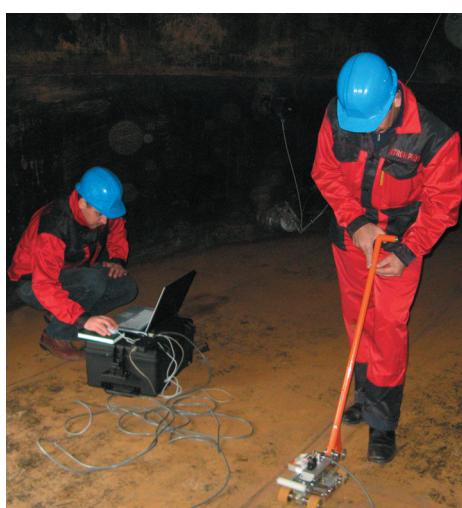
Рис. 2. Магнитный контроль днищ (а) и стенок (б) вертикальных стальных резервуаров
