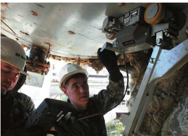
Рис. 1. Обследование колокола и нижней образующей обечайки сосуда НГСВ
