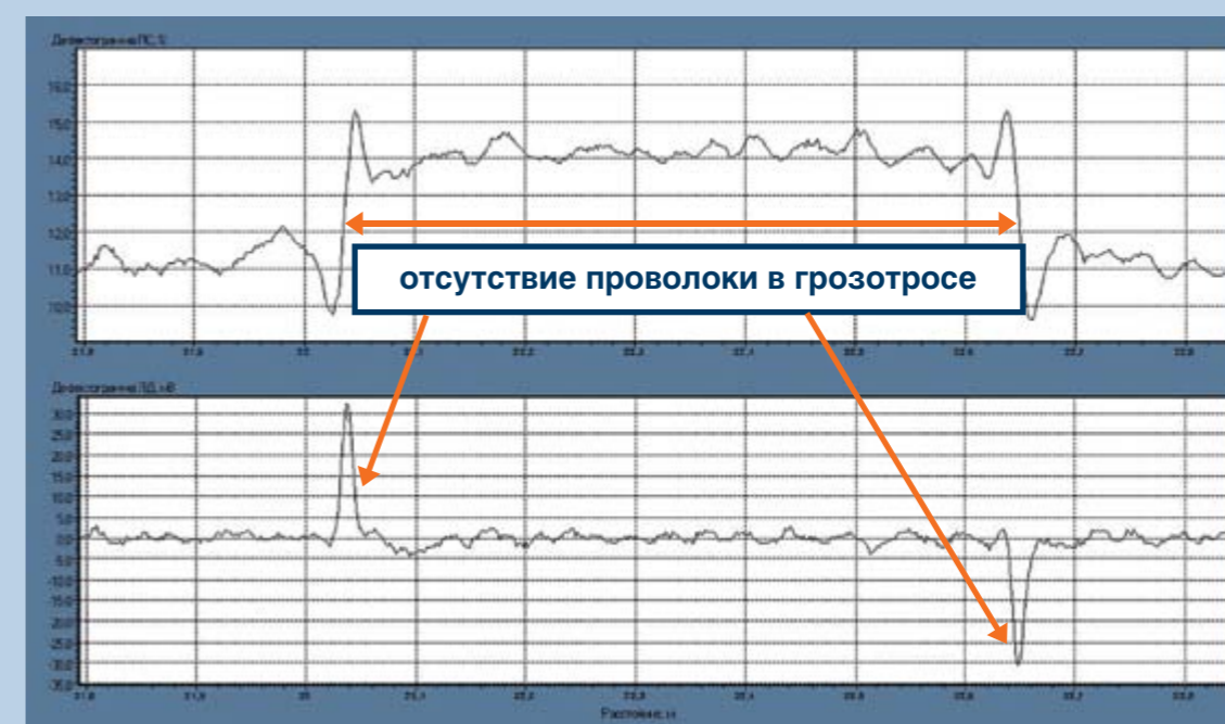
Дефектограммы грозозащитного троса с дефектами
