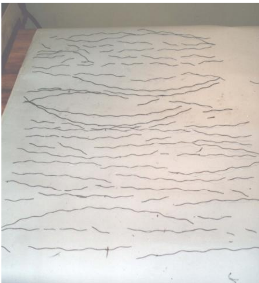
Рис. 4. Фрагменты проволок внутреннего слоя каната А
