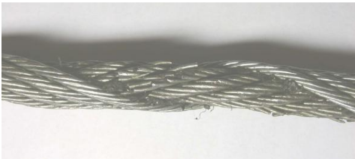
Рис. 5. Участок 1.1 каната А с частично удаленными прядями наружного слоя
