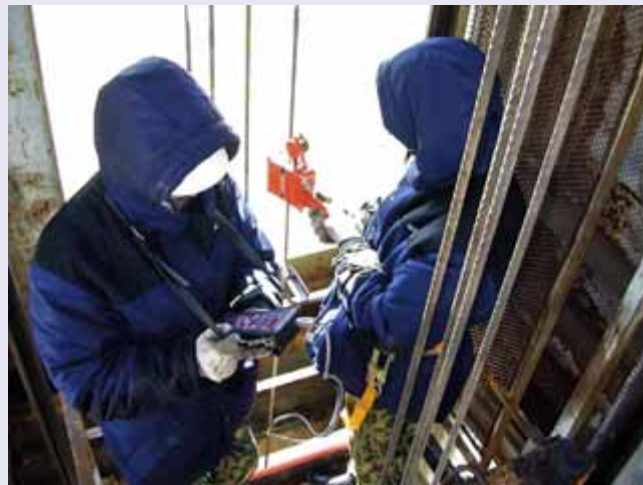
Рис. 3. Рабочее место дефектоскопистов при контроле тяговых канатов грузопассажирского лифта агрегата обслуживания РКН «Протон»
