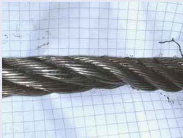
Рис. 2. Обрывы проволок и передавливания каната на участке с координатой 24,3—24,4 м
