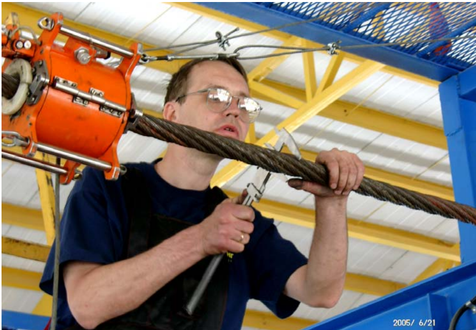
Рис. 3. Измерение диаметра счалки при дефектоскопии несуще-тягового каната
