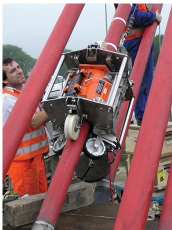
Рис. 1. Электронный блок (ЭБ) закреплен на корпусе магнитной (измерительной) головки (МГ) при контроле вантового каната
