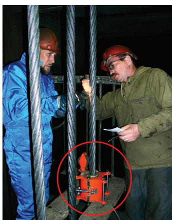
Рис. 3. Обследование каната судоподъемника специалистами ООО «Интрон Плюс» на судовой верфи в Портсмуте, Англия
