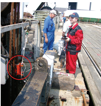
Рис. 3. Обследование каната судоподъемника специалистами ООО «Интрон Плюс» на судовой верфи в Портсмуте, Англия
