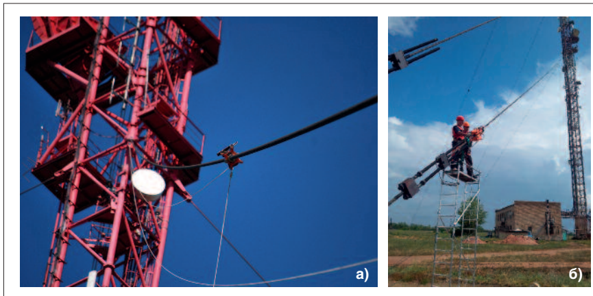
Рисунок 2 Дефектоскопия оттяжек АМС (перемещение МГ а) при помощи капронового троса или б) с использованием СУ
