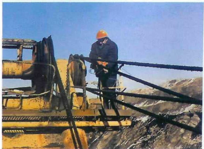
Фото 2 Дефектоскопия стреловых канатов экскаватора ЭКГ-8И
