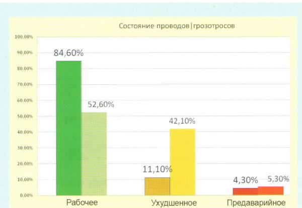
**Рис. 8. Результаты диагностики проконтролированных ВЛ**
