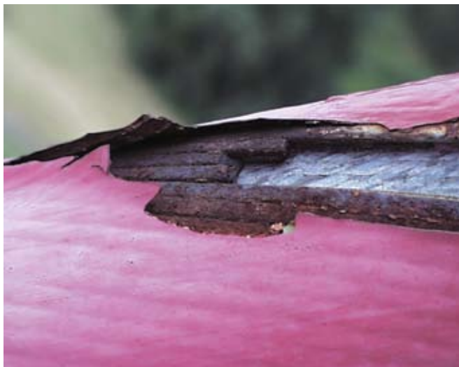
Рис. 6. Последствия нарушения замкового соединения Z-проволок наружного слоя закрытого каната
