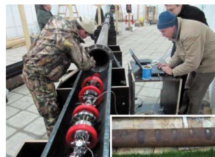
Рис. 4. Загрузка магнитного внутритрубного снаряда-дефектоскопа ВИД219 в камеру пуска испытательного («сухого») стенда
