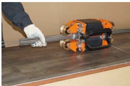
Рис. 1. Калибровка магнитного дефектоскопа ИНТРОС-АВТО с помощью имитатора стального каната
