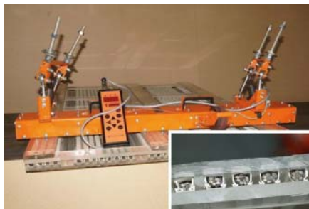
Рис. 2. Калибровка магнитного дефектоскопа ИНТРОКОН с помощью имитатора резинотросовой конвейерной ленты
