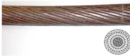
Рис. 5. Канат закрытой конструкции и его сечение
