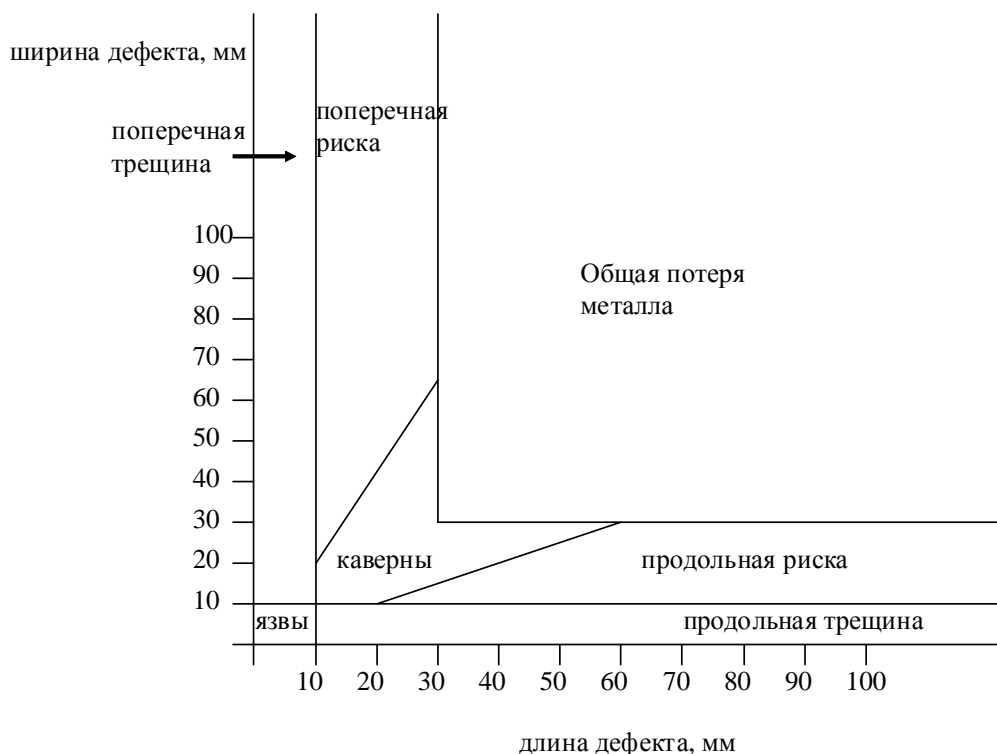
Рис. 1. Классификация дефектов нарушения сплошности металла
