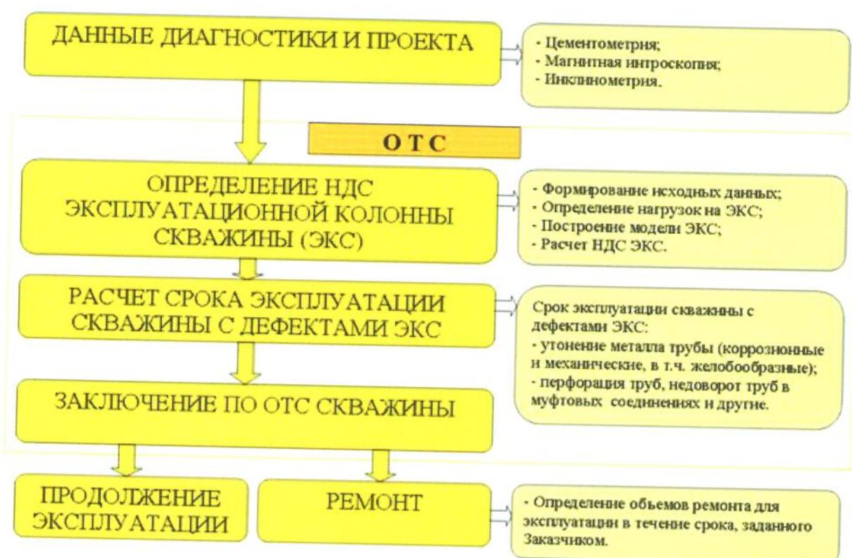
*Рис. 1. Структура ОТС скважин*
