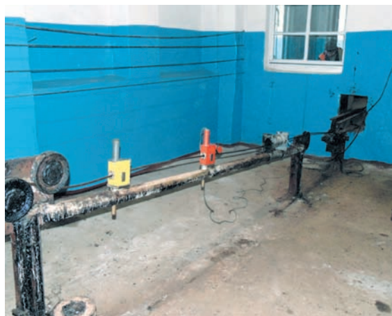
Рис. 6. Стенд для дефектоскопии кабеля
