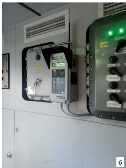
Рис. 7. ИНТРОС-АВТО при проведении мониторинга (периодического контроля) талевого каната буровой установки БУ 6000/400 ЭК-БМЧ – а) магнитная головка; б) блок управления и индикации
