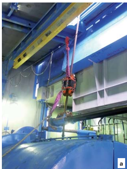
Рис. 7. ИНТРОС-АВТО при проведении мониторинга (периодического контроля) талевого каната буровой установки БУ 6000/400 ЭК-БМЧ – а) магнитная головка; б) блок управления и индикации
