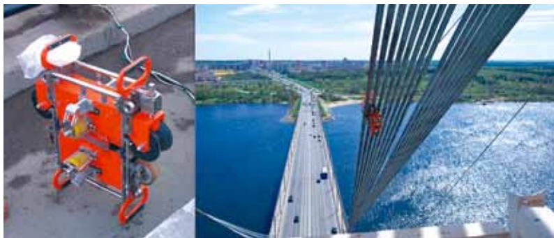
Фото 3. Плоская МГ для контроля близко расположенных канатов (Череповец)
