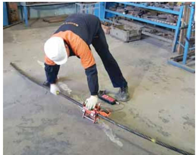
▲ Рис. 10. Дефектоскопия талевого каната ▲ Fig. 10. Wire rope defectoscopy
