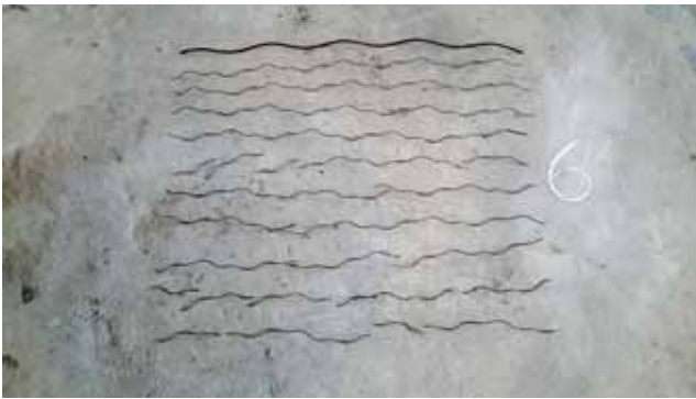
▲ Рис. 12. Проверка результатов дефектоскопии талевого каната (расплетение каната) ▲ Fig. 12. Checking the results of flaw detection of the wire rope (rope unweaving)
