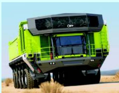
Производители традиционных карьерных самосвалов создают машины со все большей грузоподъемностью, используя традиционную двухосную конструкцию и увеличивая размер составляющих компонентов. В итоге сдерживающим фактором роста грузоподъемности карьерных самосвалов оказались крупногабаритные шины. При этом увеличение грузоподъемности ведет к росту размеров агрегатов: двигателей, коробок передач, трансмиссии и проч.; усложнению их конструкции и росту затрат на их изготовление.
