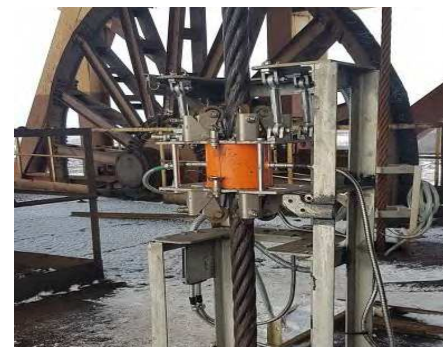
Фиг. 2 УСТРОЙСТВО НАВЕСКИ МАГНИТНОЙ ГОЛОВКИ. (Оператор подводит устройство навески к канату с открытой магнитной головкой и закрывает ее на канате)
