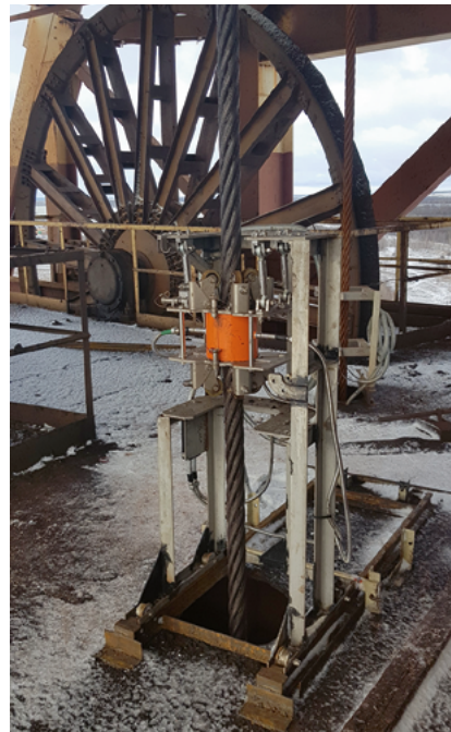
Рис 1. Автоматизированный дефектоскоп ИНТРОС-АВТО
