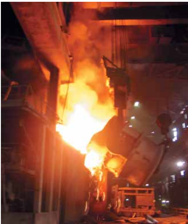
▲ Рис. 1. Заливка жидкого чугуна в конвертер ▲ Fig. 1. Pouring-in of molten iron into the converter
