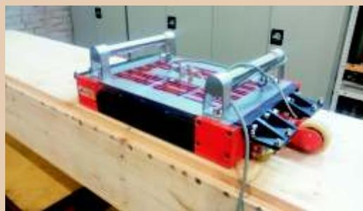
Рис.3. Магнитный дефектоскоп
