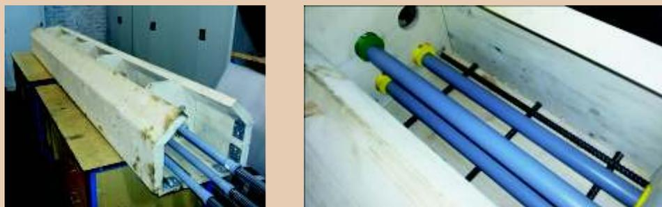
Рис.2. Внешний вид имитатора нижнего пояса ЖБ балки и его внутренняя структура
