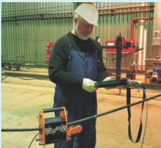
Рис. 4. Контроль ГК дефектоскопом ИНТРОС с МГ6-26.
