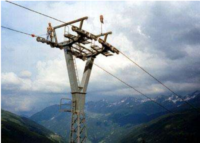
Рис. 1. Магнитная головка ИНТРОС, установленная на опоре канатной дороги в Австрийских Альпах.
